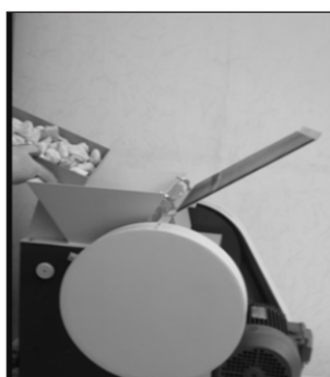
Рис. 6. Дроблення щебеню на щековій дробарці марки ПЦД 10
